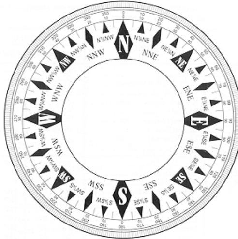
**Determinar el Acimut Inverso** - Si no sabes el grado en el que has caminado, todo lo que necesitas hacer es regresar un grado (acimut inverso) y esto te dará la dirección de la cual viniste. Una manera rápida y segura de imaginar el acimut inverso es usar las siguientes reglas:
