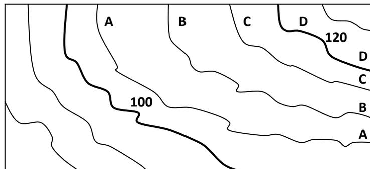
Si uno se fija, notará enseguida que la elevación se muestra hacia la esquina superior derecha del mapa. Luego, al leer las líneas de contorno, la línea A equivale a 105 pies, la línea B, a 110 pies, la línea e a 115 pies, y la línea D equivale a 120 pies.
